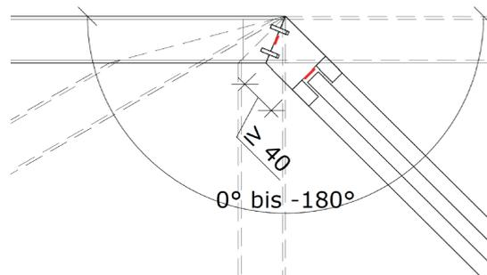
1.15 1-flg. Türe Vollspankern, stumpf, mit verdecktem Dämmschichtbildner, ohne Glas, EI30
